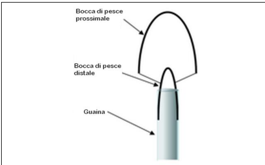
Figura 12 Cuffia prossimale per l'estensione, parzialmente dispiegata
